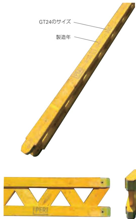
木材唯一の欠点であった材質の安定性の問題も、集成材による製法でトラスを構築することにより解決したGT24。長期間、変形することのない精度の高さが自慢です。さらに釘打ち可能と木材のもつメリットそのままです。また、鋼製ビームのようなムクリがなく梁受け部分の問題もSTシステムを使用することにより施工性もアップします。
