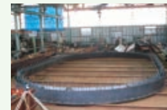
ケーソン刃口金物
